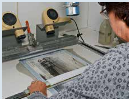
Entfernen der überschüssigen Farbe mit Chemie.
