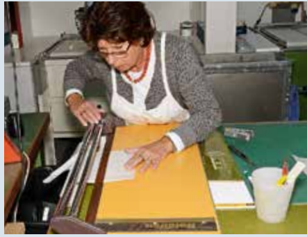
Zuschneiden von fertigen Anreibefolien.
