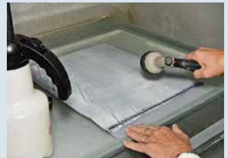
Entfernen der Fotoschicht mit Flüssigkeit.
