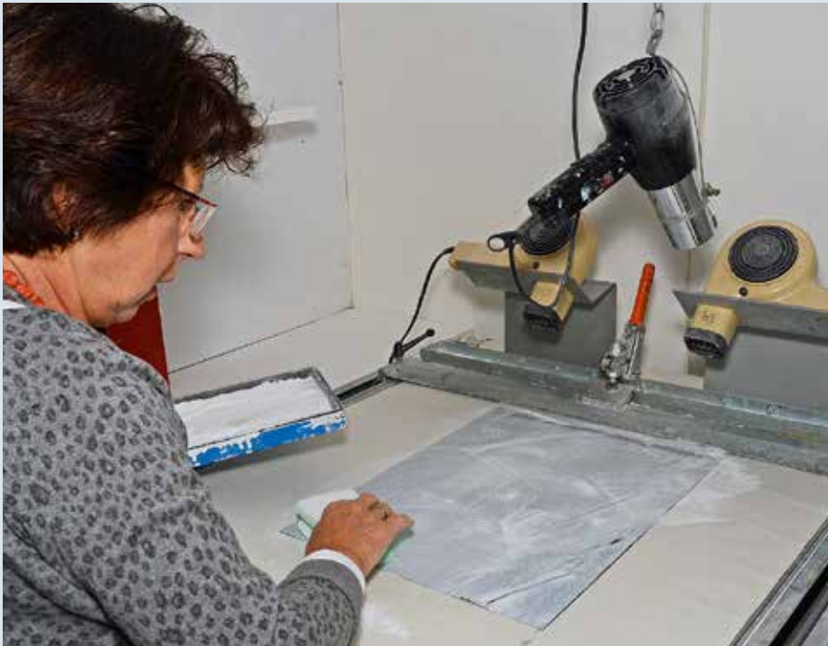
Einpudern der Folie für den Auftrag der Fotoschicht.
