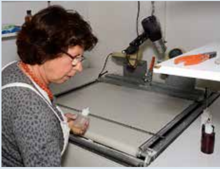
Vorbereitung des rohen Bogens mit Trennlack.
