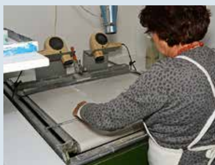
Bestreichen der fertigen Folie mit Klebstoff.
